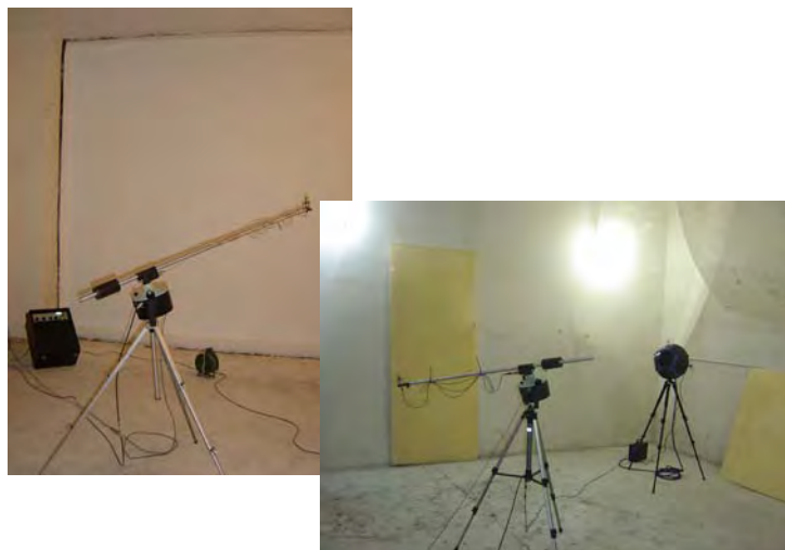
شکل ۳- اندازه‌گیری تراز صدا و زمان واخنش در آزمایشگاه صدابندی
